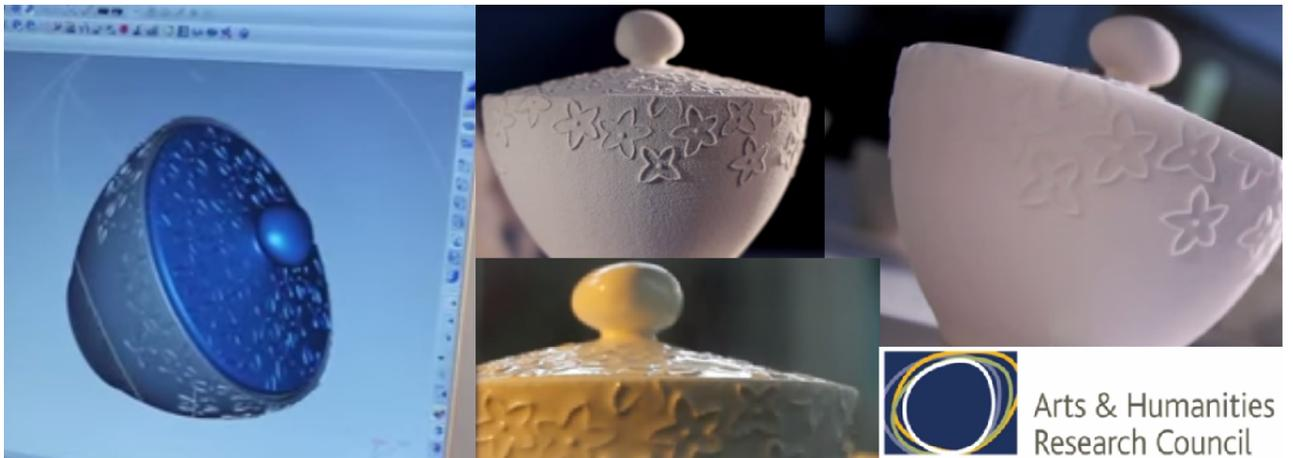
Figura 4.4.6: Hoskins, S. 2012. Objeto cerámico modelado con impresión 3D en cerámica.
