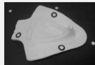
Imagen 7: Módulo cerámico "escama", vista inferior con tres sensores para escaneo, colocado sobre una superficie negra con sensores que permite el envío de datos de escaner.
