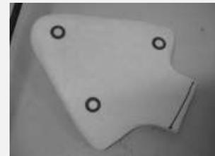
Imagen 6: Módulo cerámico "escama", vista superior con tres sensores para escaneo.
