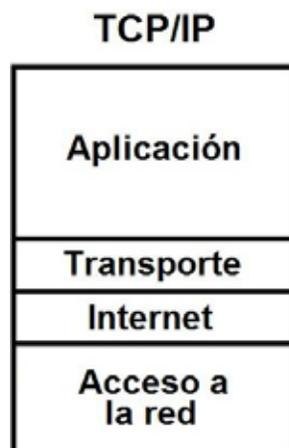
**Figura 5.2** Capas del modelo TCP/IP.
