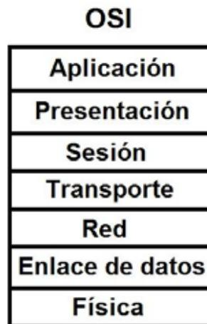
**Figura 5.1** Capas del modelo OSI.
