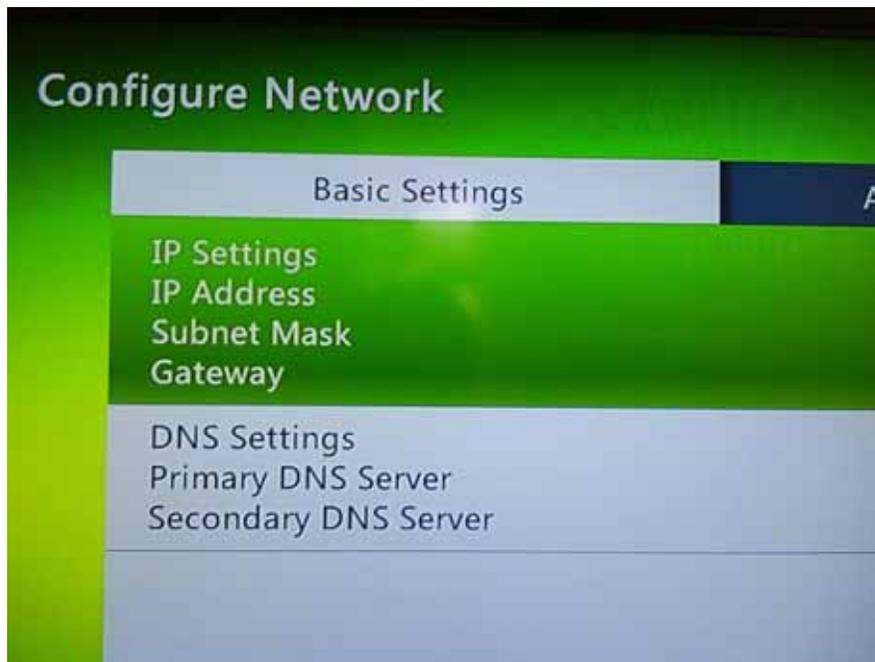
Fig. 11: Configuración manual de red
