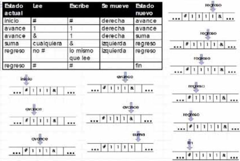
Fig 2.2 Ejemplo de los pasos a realizar por una Máquina de Turing
