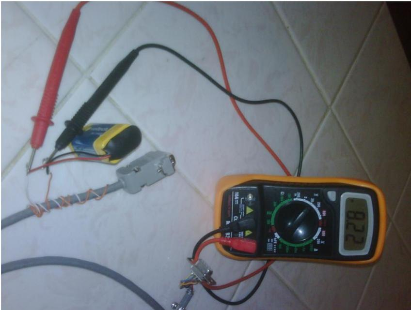
Figura 20.2 suministro de constante positiva de voltaje al pin DTR (pin 4) mediante pila de 9 volts.
