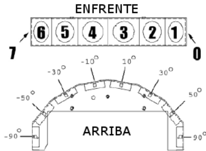
Figura 4. Arreglo de Sonares
