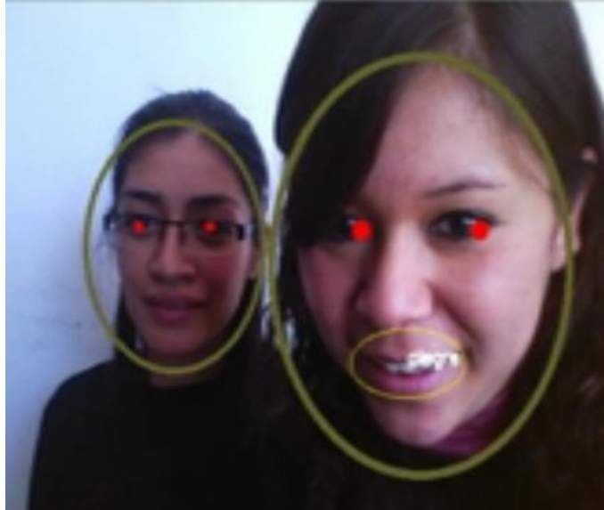
Figura 18. Muestra a dos personas de frente a la cámara, donde les reconoce su rostro, ojos, una de ellas con estado de alegría, y la otra muestra un gesto de sonrisa pero muy tenue, por ello no es captada por el sistema.
