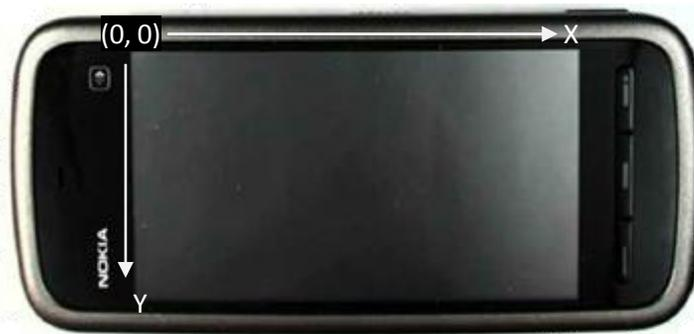
Figura 3.7: Origen de coordenadas y dirección en pantallas de dispositivos móviles.
