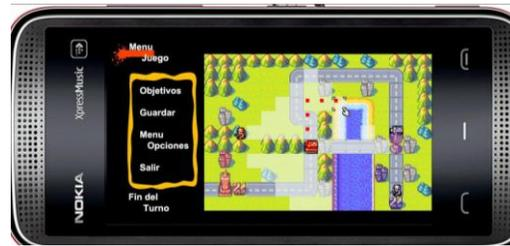
Figura 3.15: Se observan las celdas iluminadas sobre las cuales la unidad se puede desplazar, los puntos rojos son la ruta establecida por el algoritmo  $A^*$ ; desde la posición actual de la unidad (origen) hasta la posición destino.
