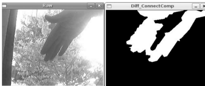
Figura 11: Ejemplo de la aplicación de Componentes Conectados
