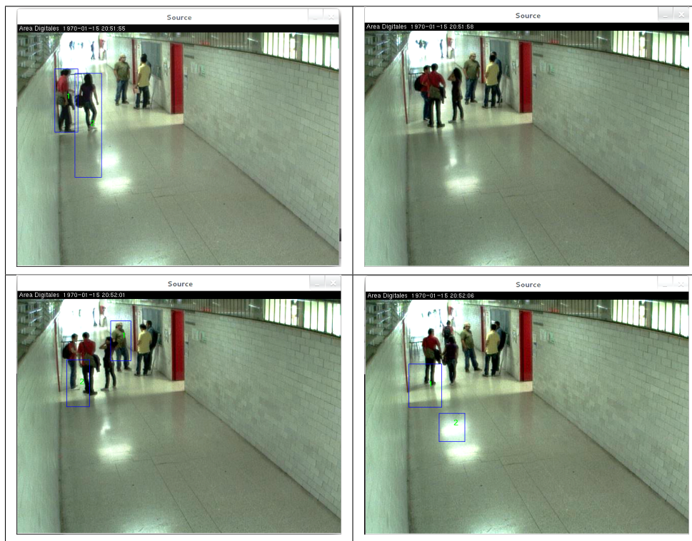
Figura 34: Resultado del algoritmo de tracking con oclusión
