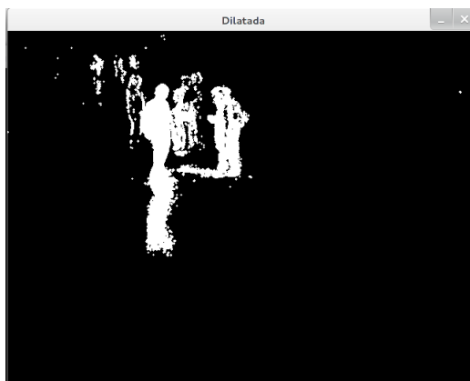
Figura 19: Resultado de Dilatación sobre la segmentación
