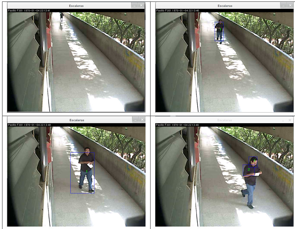
Figura 32: Resultado del algoritmo de tracking con 1 persona
