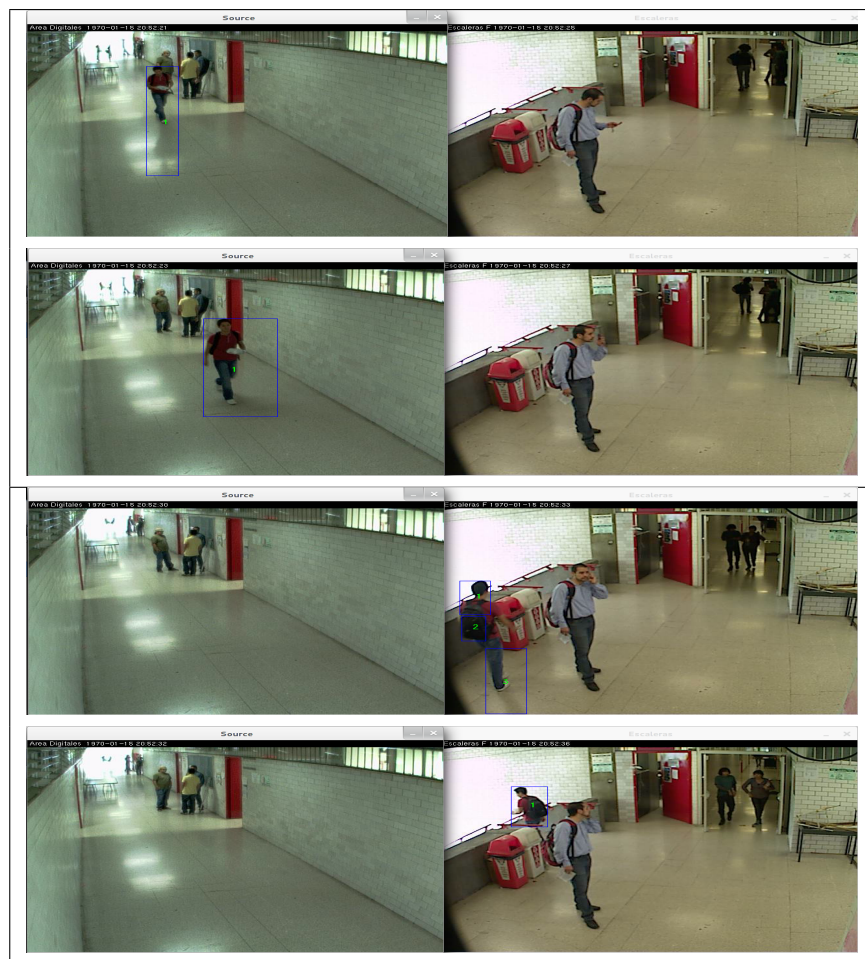
Figura 36: Resultado del algoritmo en tracking multicámara
