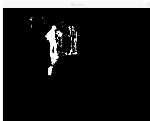
Figura 20: Resultado de Erosión sobre la segmentación
