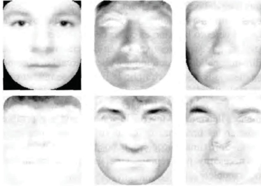
Figura 4: Primeras cinco Eigenfaces generadas a partir de 57 imágenes de rostros normalizados.
