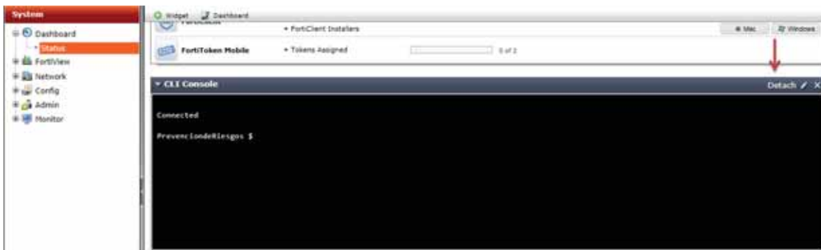
Figura 92. Ruta para entrar a consola de Fortigate.
