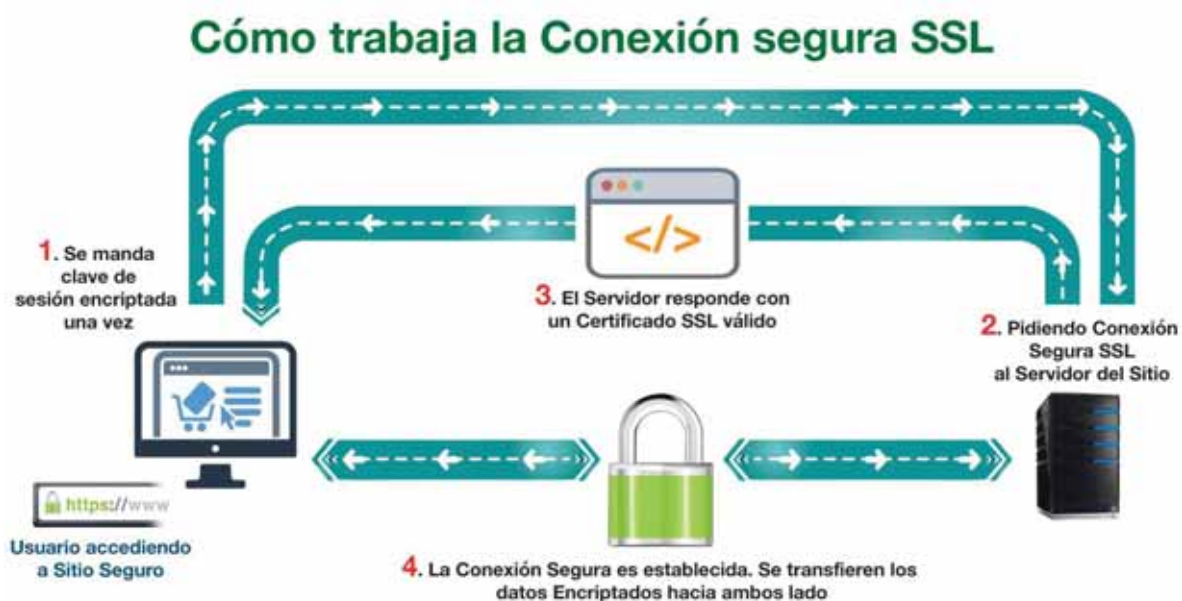
Figura 3. Funcionamiento de SSL
