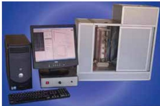
Figura 2.16 Ilustración de un equipo para análisis de espumas FOAMSCAN [20].
