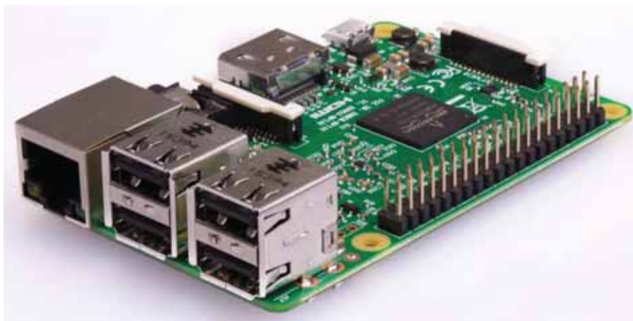
Figura 1.1 Sistema Embebido Raspberry Pi 3
