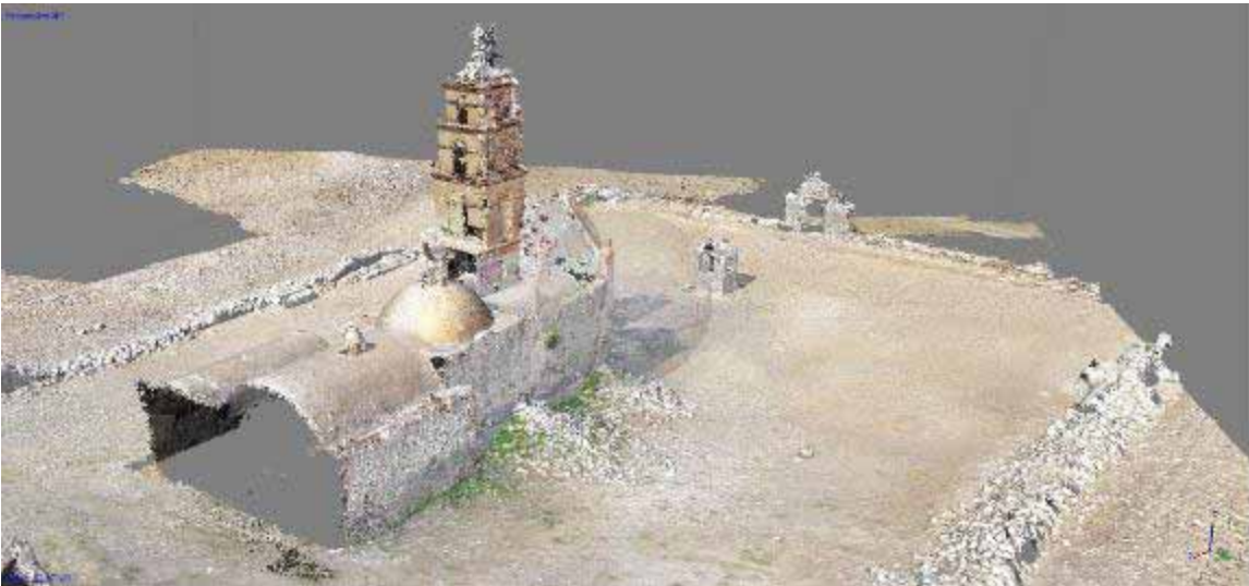
Figura 46. Dense Point Cloud del procesamiento en PhotoScan de Agisoft.
