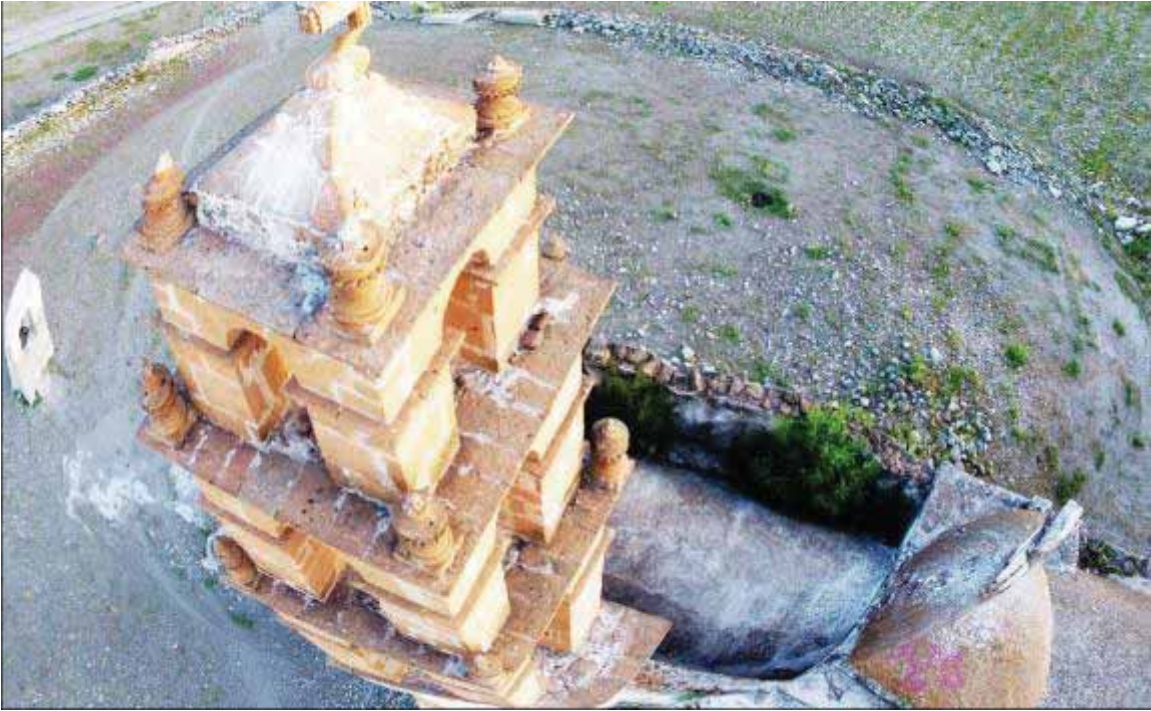
Figura 7. Distorsión de Barril, se produce una distorsión sobre la retícula, haciendo que las celdas centrales se curven hacia los extremos, ocasionando que el objeto se vea más grande.
