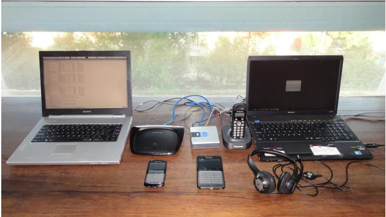
**Figura 9. Implementación de Red LAN con el servidor, *router*, ATA, teléfono convencional, dispositivos Android y *softphone***
