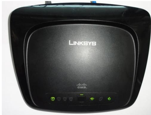
El router permite acceder a Internet a través de una conexión inalámbrica, transmite a velocidades de hasta 54 Mbps, o por medio de sus 4 puertos conmutados. También puede usar el router para compartir recursos tales como computadores impresoras y archivos. La configuración del router es fácil utilizando para ello un explorador.
