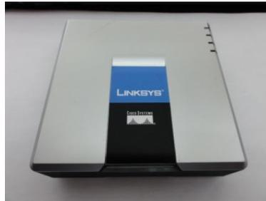
EL ATA PAP2 de Linksys cuenta con dos puertos para conectar teléfonos convencionales, un puerto Ethernet para conectar el ATA a la red y la salida de alimentación de corriente.
