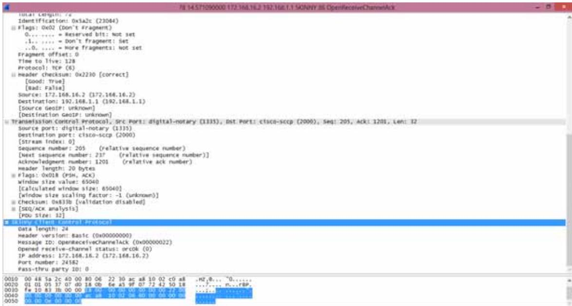
Figura 33 Detalle del Paquete SKINNY.
