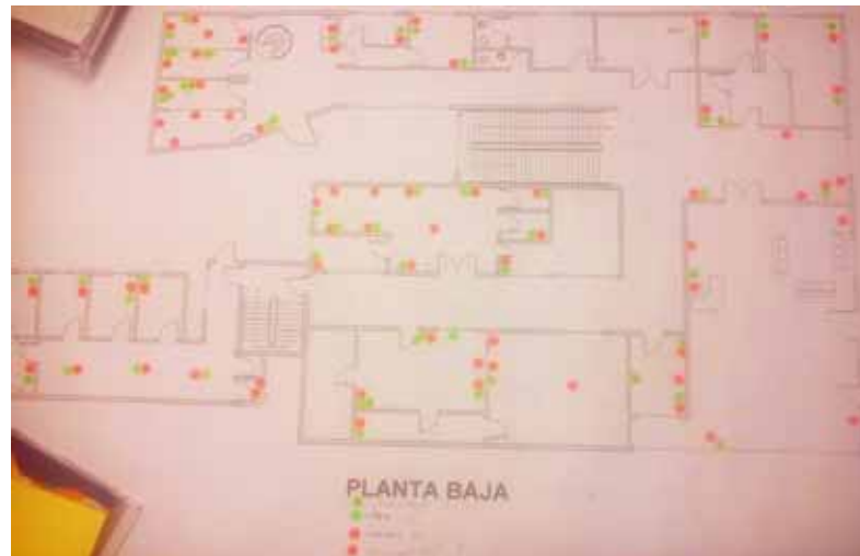
Imagen 5: diseño de la distribución física del nuevo medio de transmisión para la planta baja.
