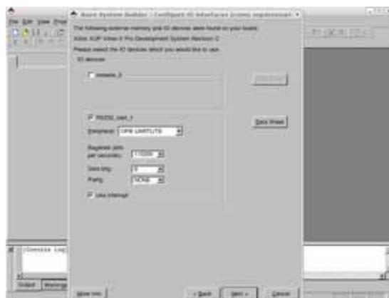
Figura 2.8: Pantalla de configuración de RS232
