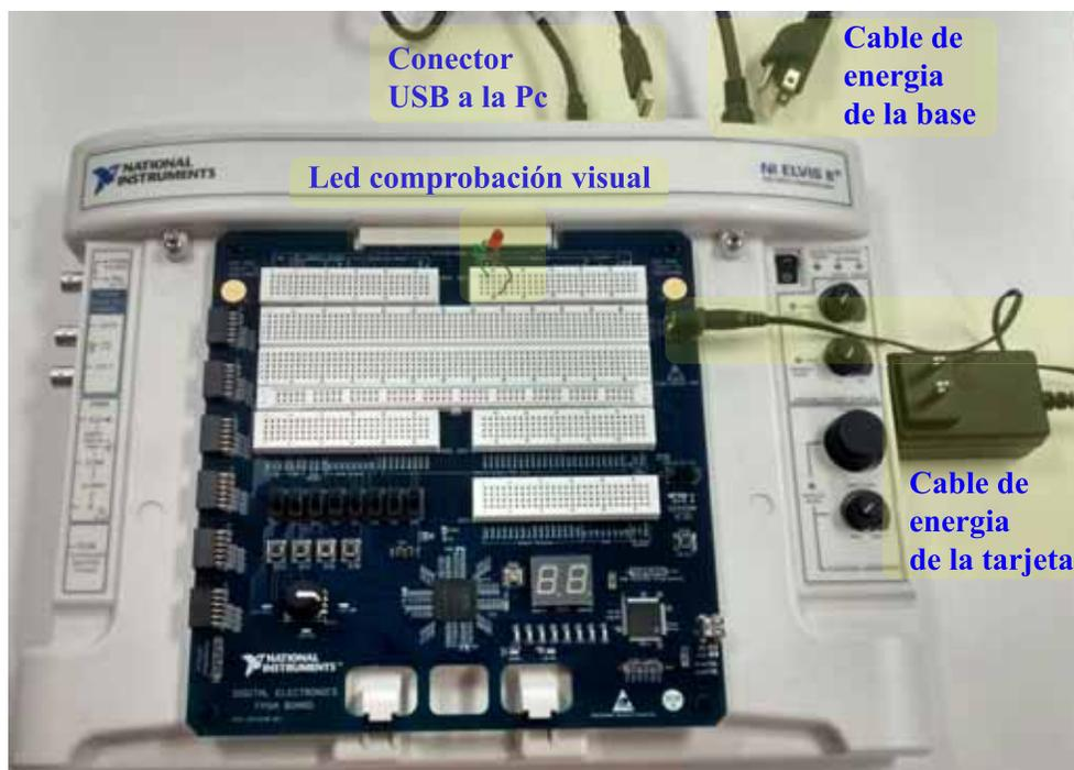
Figura 6.1: Conexiones de la base y tarjeta FPGA.
