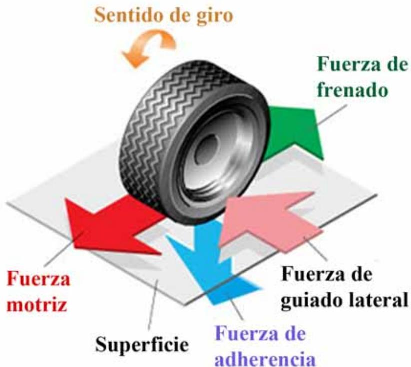
Figura 1.2: Diagrama de fuerzas que actúan sobre el neumático.
