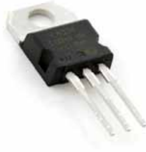
30 Figura: Regulador de voltaje a 3.3 voltios (LM7833).
