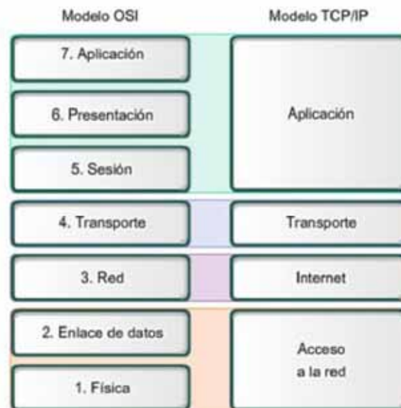
2 Figura: Comparación del modelo OSI y del modelo TCP/IP.
