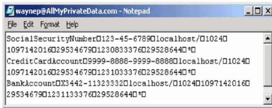
13 Figura: Ejemplo de un archivo Cookie, con datos del cliente que puede utilizar el servidor.
