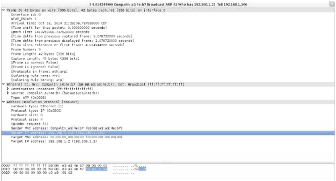
49 Figura: Capturas de tráfico en la red de los dispositivos. Solicitud ARP realizada por el cliente.
