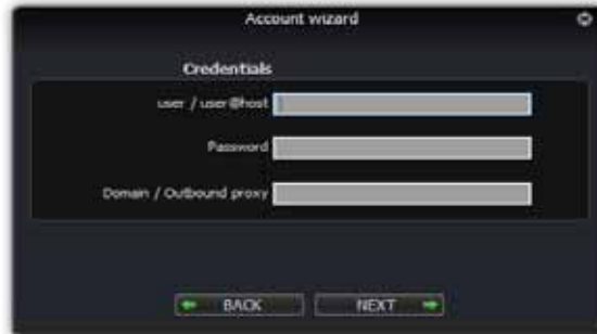
Fig. 5 En la imagen anterior se muestra los campos que se tienen que llenar los cuales corresponden al numero de extensión, contraseña y dirección del servidor.
