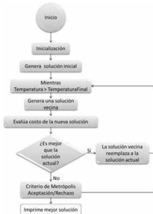
Figura 1: Diagrama de flujo Recocido Simulado.
