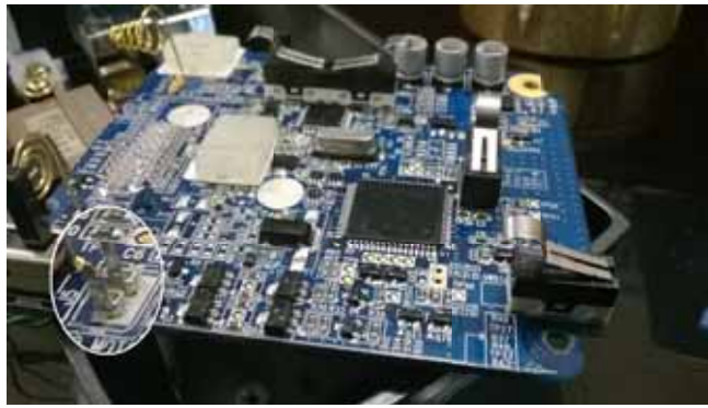
Figura 2.4: Placa base y sus correspondientes pines para el control del motor ubicados en la esquina inferior izquierda.
