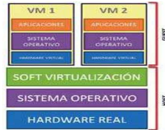
*Figura 12. Esquema funcional para la virtualización con hipervisor alojado.*
