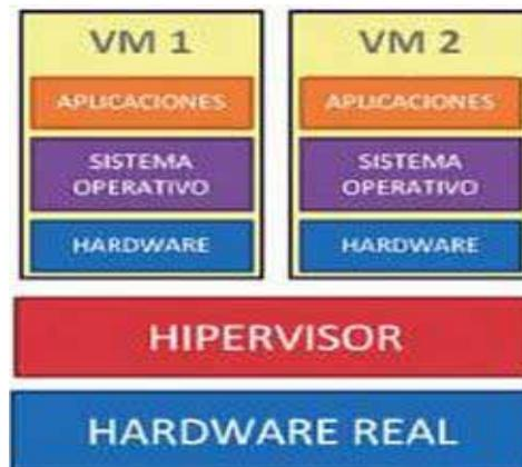
*Figura 11. Esquema funcional para la virtualización con hipervisor nativo.*
