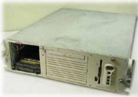
*Figura 8. Uno de los primeros servidores físicos x86 que reemplaza a los antiguos mainframes.*
