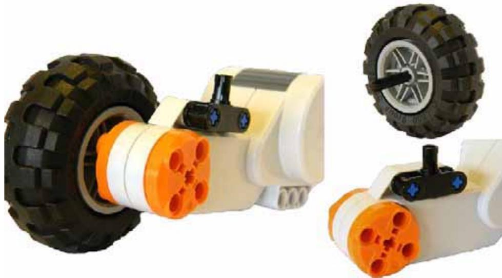
**Figura 16. Armado de motores con sus correspondientes ruedas.**
