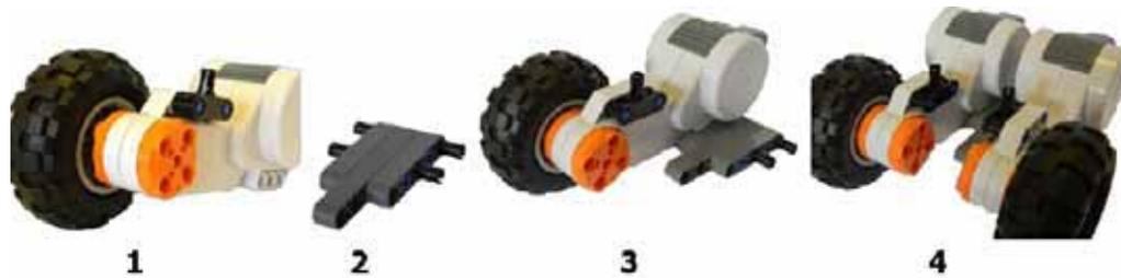
**Figura 19. Unión de los motores con el chasis.**
