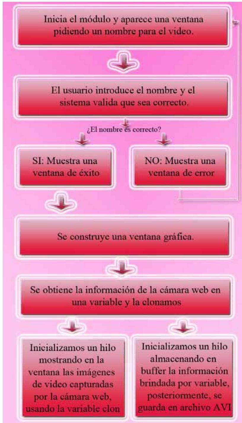
Figura 11. Diagrama de ejecución del módulo de grabación de video.
