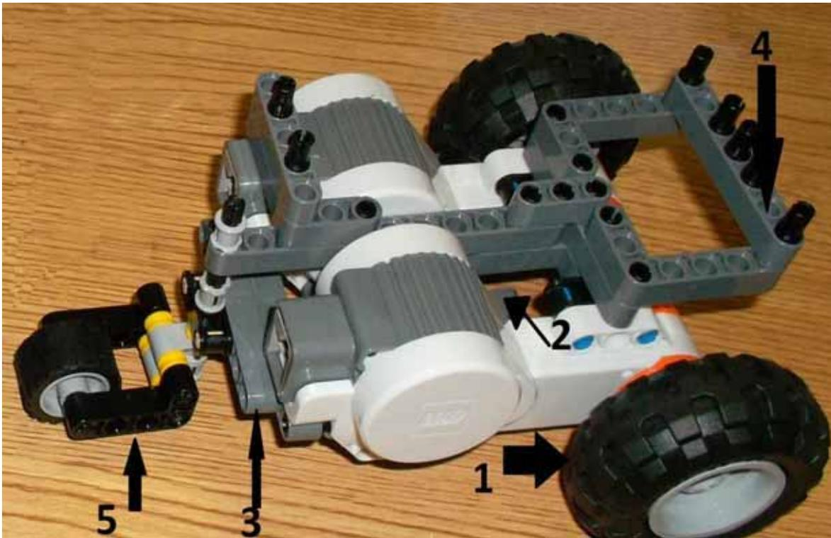
Figura 14. Señalamiento de las 5 partes principales del robot.
