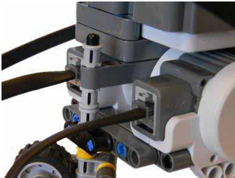
**Figura 30. Conexión de cables a los motores de las ruedas.**
