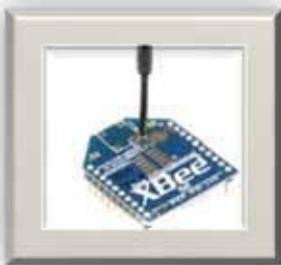
**Figura 6.5.1.1** Módulo XBee serie
