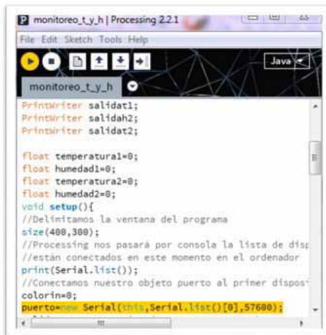
**Figura 7.4.** Implementación de Processing para leer el puerto serie y almacenar los datos.
