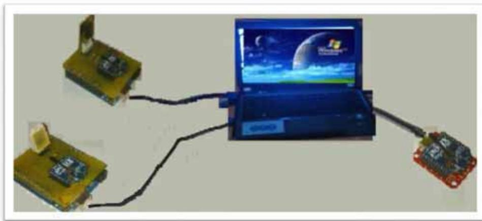
Figura 7.10 Red de monitoreo usando tecnología Zigbee.
