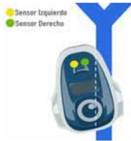
Figura 8. Ambos sensores de línea sensando blanco.
