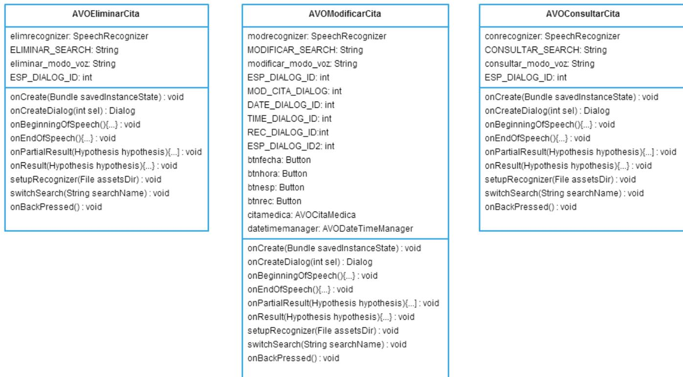
Figura 10. Clases del paquete AVOActivityControllers (parte 2/4)
