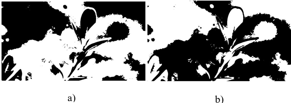
Figura 5. 19. Visualización del resultado al invertir los colores de la imagen usando la técnica *imcomplement*. a) Imagen binaria. b) Imagen con colores invertidos
