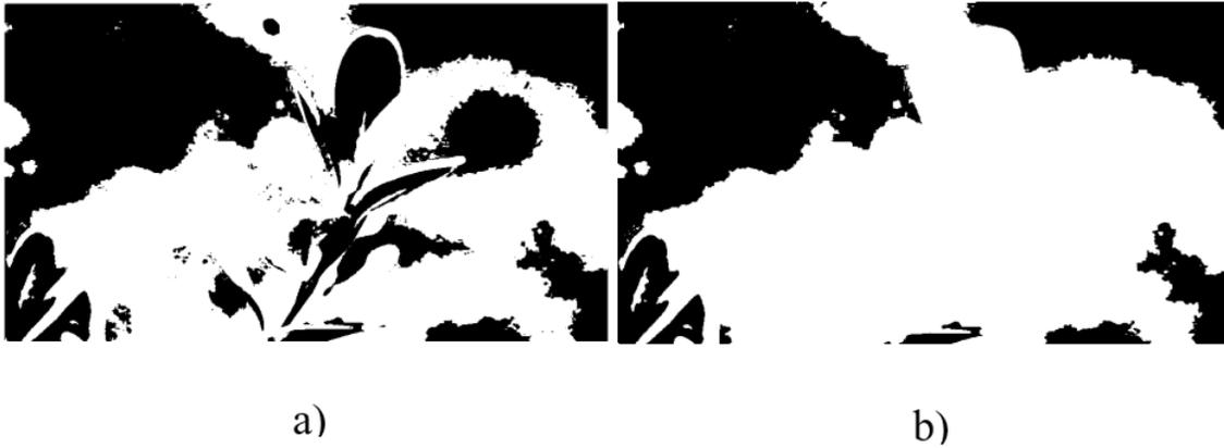
Figura 5. 15. Visualización del resultado al llenar los huecos contenidos en cada uno de los objetos de la imagen con la técnica *imfill*. a) Imagen binaria. b) Imagen huecos rellenos
