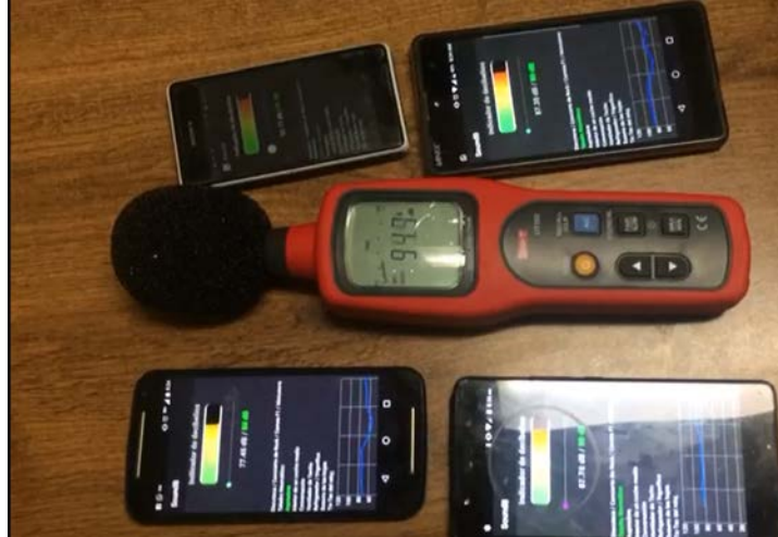
Figura 41: Toma de ruido con varios dispositivos móviles y un sonómetro profesional.
