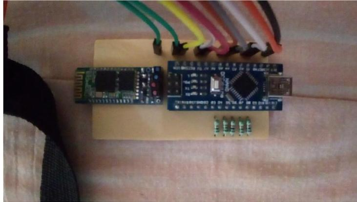
Figura 5. Arduino Nano cargado con el código del módulo codificador
