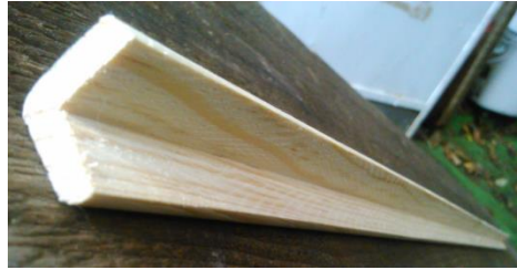
Figura 72. Material base en madera de pino.
