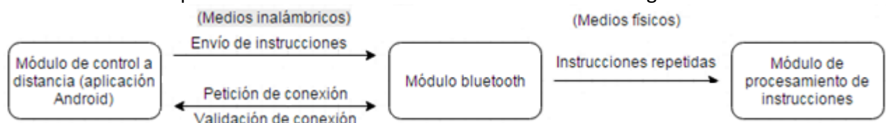
Figura 15. Descripción general del módulo de recepción de instrucciones por bluetooth.
