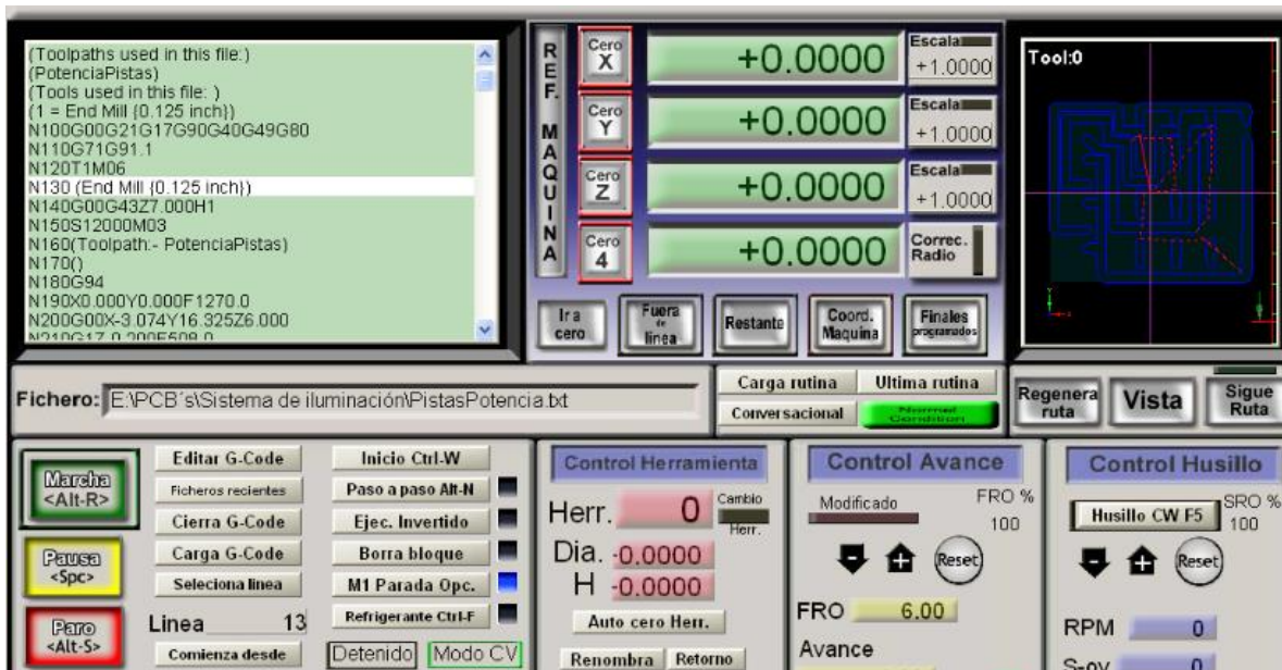
Figura 63. Código G cargado en el software CNC Mach 3.
