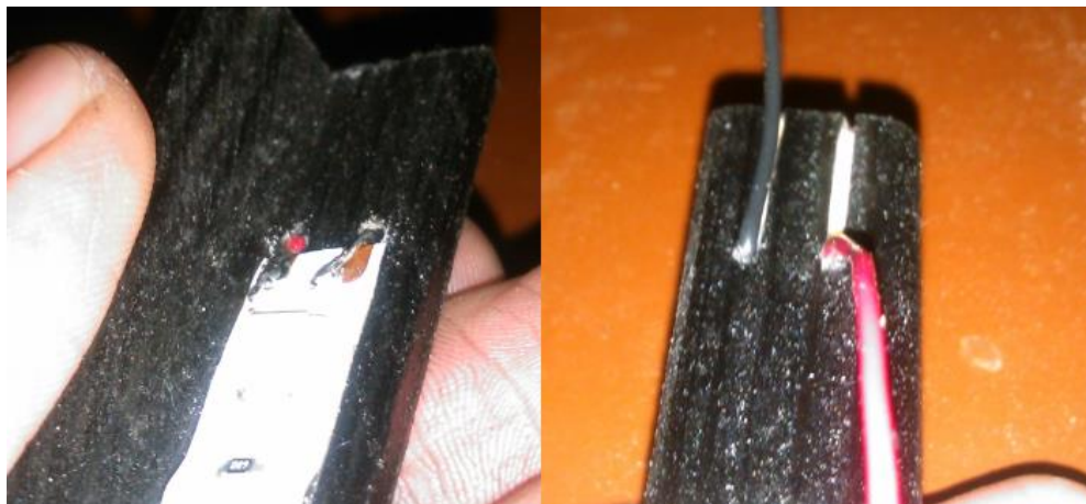
Figura 78. Extremo del módulo de iluminación central, parte delantera y posterior.
