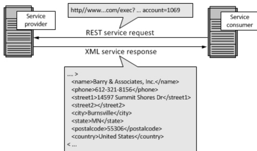
Figura 2. Comunicación llevada a cabo por un servicio web REST.
