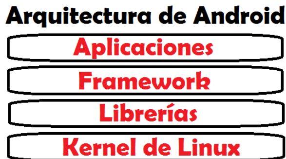
Figura 4. Sistema de capas del sistema operativo Android.
