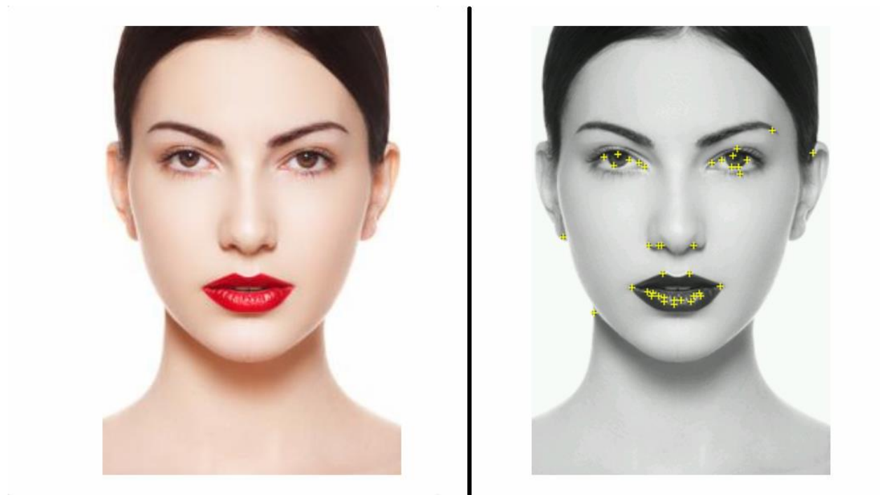
Figura 3.1. Imagen seleccionada para el reconocimiento por parte de la aplicación (izquierda) y puntos característicos elegidos por Vuforia para dicho reconocimiento (derecha)
