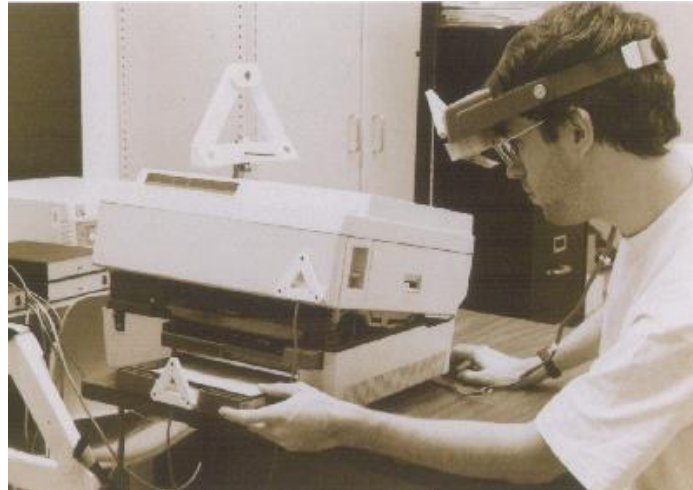
Figura 1.5. KARMA, dispositivo de realidad aumentada para mantenimiento de impresoras [24]
