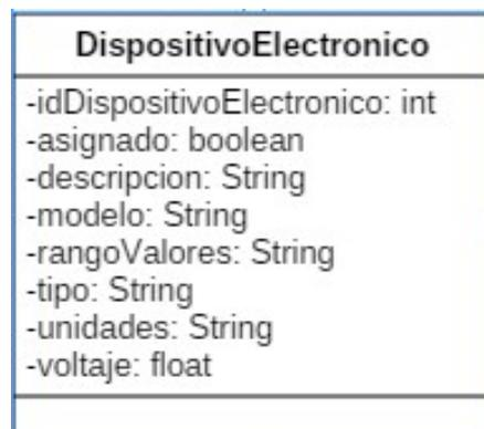
Figura 4. Clase DispositivoElectronico
